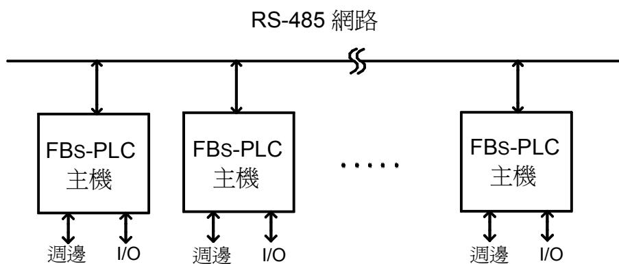
如圖示，透過高速 RS-485 網路，可輕易地將 2~254 台主機連結起來(各 PLC 之站號不得重複)，而僅需在其中一部主機中鍵入 CPU Link 指令並使之執行，該主機即會變成 CPU Link 網路中之主站(Master)，其餘之僕站之主機無需任何指令配合。主站 CPU 會自動抓取網路上所有主機(含主站本身)特定區域之資料或數據，置入網路上各主機之共同資料區(CDM)，使網路上所有主機均能分享彼此之數據資源，使原本 I/O 有限之小型單機系統連結成一龐大之 PLC 系統。
