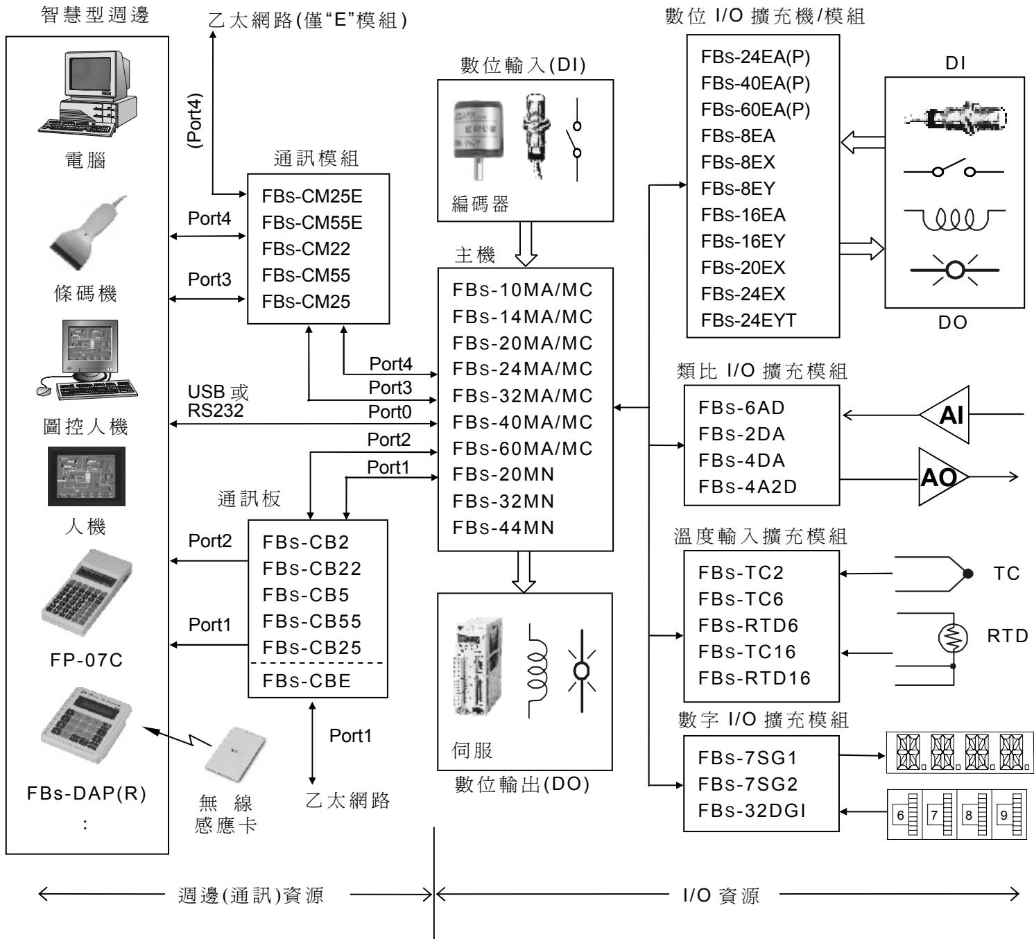
以 FBS-PLC 之 I/O 而言，最大可組成 256 點數位輸入(DI)，256 點數位輸出(DO)，64 字元(Word)之數值輸入(NI)，64 字元之數值輸出(NO)，配合多種特殊界面模組，可直接連接諸如 Thermocouple, RTD, 7 段 LED 顯示器，指撥開關等元件，如上圖右側所示。
