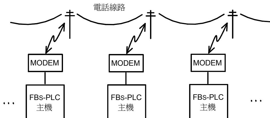
除上述透過區域性網路連結外，FBS-PLC 亦可透過 MODEM 經由電話線(可為專用線或公共撥接電話線路)作遠距離多台 PLC Link(若為公共撥接電話線路主站 PLC 會主動逐一地撥號連結所有僕站 PLC)。
